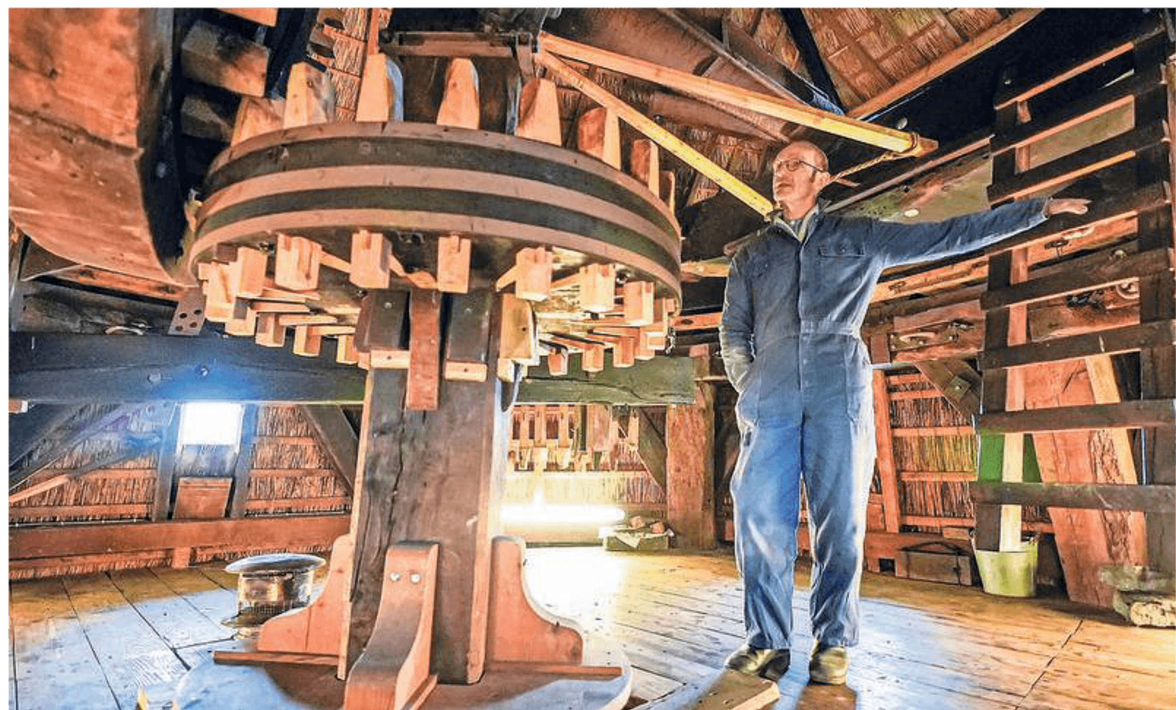
De tandwielen van het gemaal.
